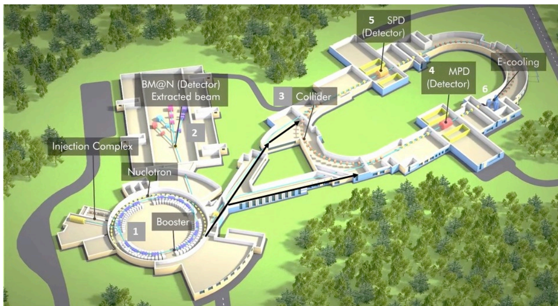
Рис. 2. Схема расположения основных ускорителей и экспериментальных установок Комплекса NICA
