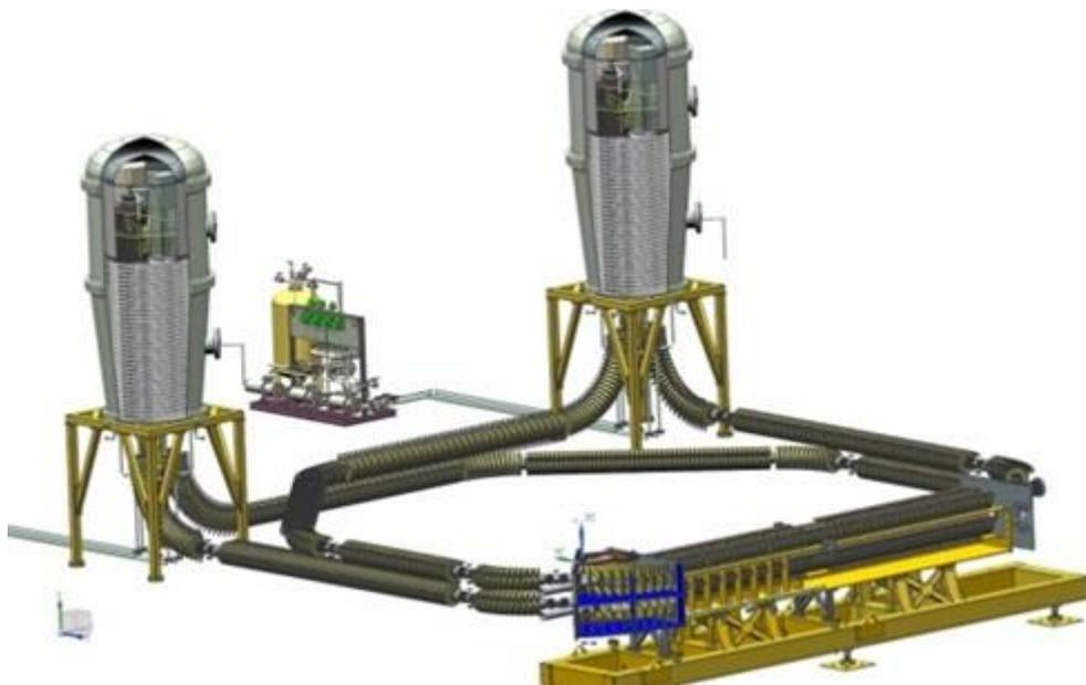
Рис. 23. Общий вид системы электронного охлаждения пучков коллайдера NICA (проект ИЯФ им. Г.И.Будкера СО РАН).
