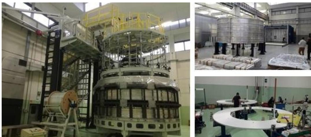
Рис. 27. Первый модуль сверхпроводящей катушки соленоида на намоточной машине (слева), первый модуль опорного цилиндра сверхпроводящей катушки и печь компаундирования (справа сверху), намотка теплых обмоток торцевых корректирующих магнитов (справа внизу).
