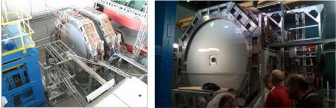
Рис. 39. Дрейфовые камеры внешнего трекера установки *BM@N*.
