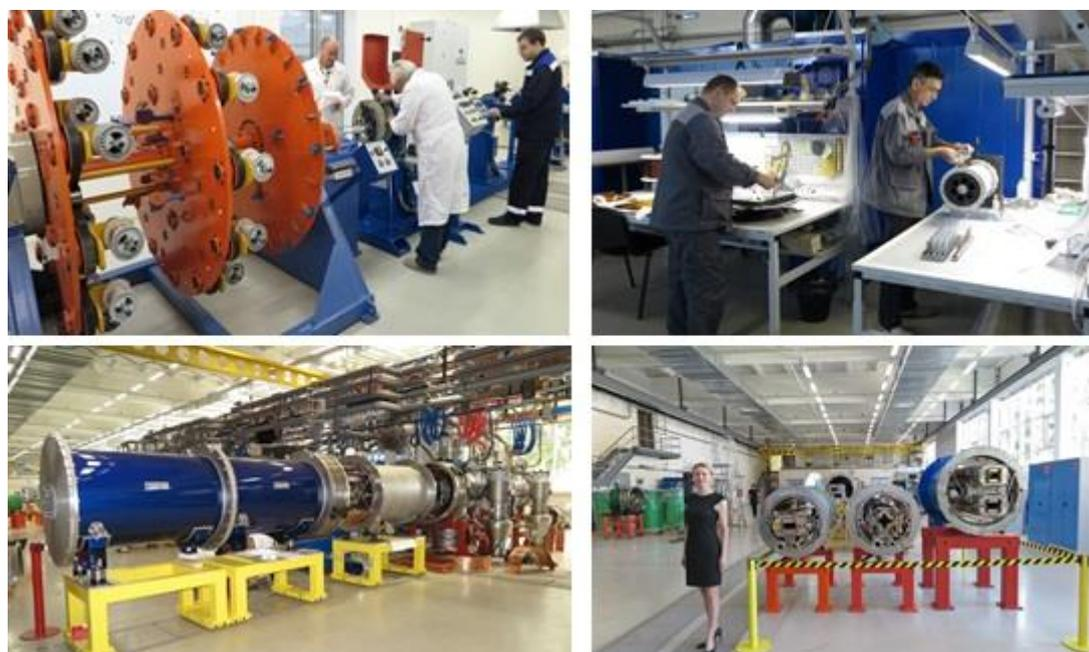
Рис. 14. Машина для производства сверхпроводящего кабеля (слева сверху), участок для изготовления обмоток магнитов (справа сверху), участок криогенных испытаний магнитов (внизу слева) и образцы собранных магнитов в криостатах (внизу справа – дипольный и квадрупольный магниты Бустера и двухпертурный дипольный магнит для двух колец коллайдера).
