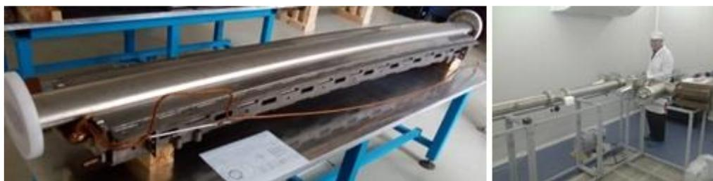
Рис. 18. Вакуумная камера дипольного магнита (слева) и стенд для испытания элементов вакуумной системы Бустера (справа).
