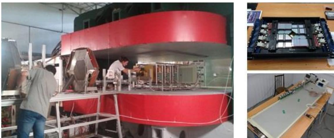
Рис. 38. Спектрометрический магнит СП-41 установки VM@N (слева) с размещенными перед ним пропорциональными камерами, а внутри - передним двухкоординатным кремниевым микростриповым детектором (справа сверху) и набором GEM детекторов (детектор размером  $163 \times 45 \text{ см}^2$  справа внизу).
