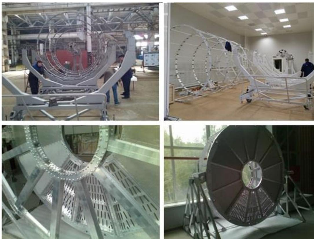
Рис. 32. Оснастка для монтажа и сборки ТРС в чистой комнате ЛФВЭ ОИЯИ (сверху) и прототипы фланца и сервисного «колеса» для ТРС (внизу).
