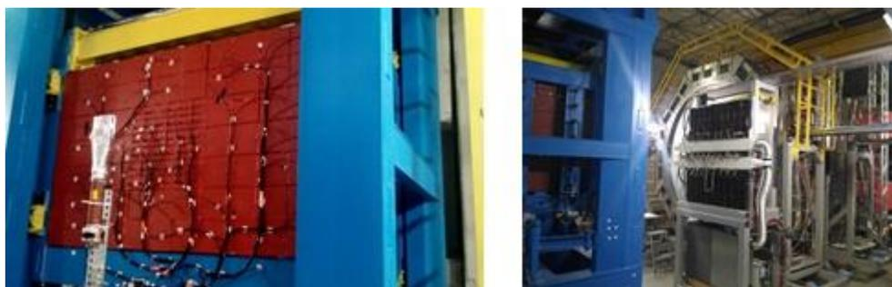
Рис. 41. Адронный калориметр малых углов ZDC на подвижной платформе (слева) и элемент электромагнитного калориметра ECAL (справа) установки *BM@N*.
