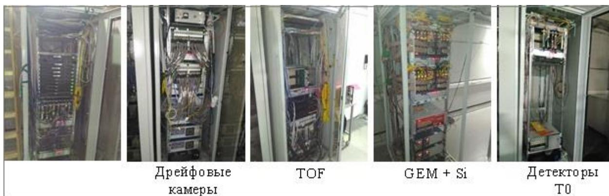
Рис. 43. Система синхронизации детекторов, распределения триггера и формирования события (слева) и подсистемы сбора данных с основных детекторов  $BM@N$ .
