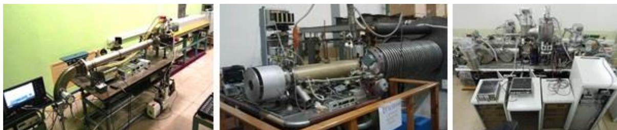
Рис. 10. Действующие источники заряженных частиц проекта «Комплекс NICA»: лазерный (слева), электронно-струнный КРИОН-6Т (в середине) и поляризованных ионов (справа).
