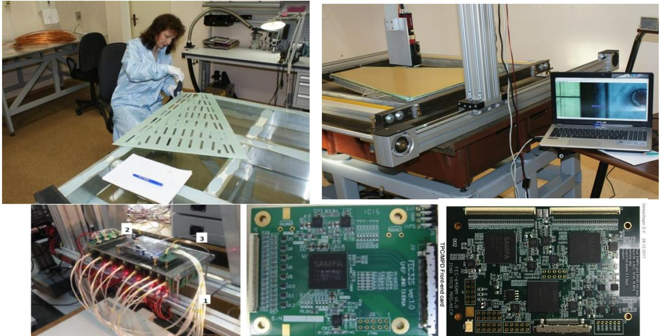
Рис. 31. Создание и тестирование считывающих камер ТРС (сверху); 512-канальная система считывания данных на базе чипов PASA и ALTRO (внизу слева), 32-канальная (внизу посередине) и 64-канальная (внизу справа) платы считывающей электроники на базе чипа SAMPA.
