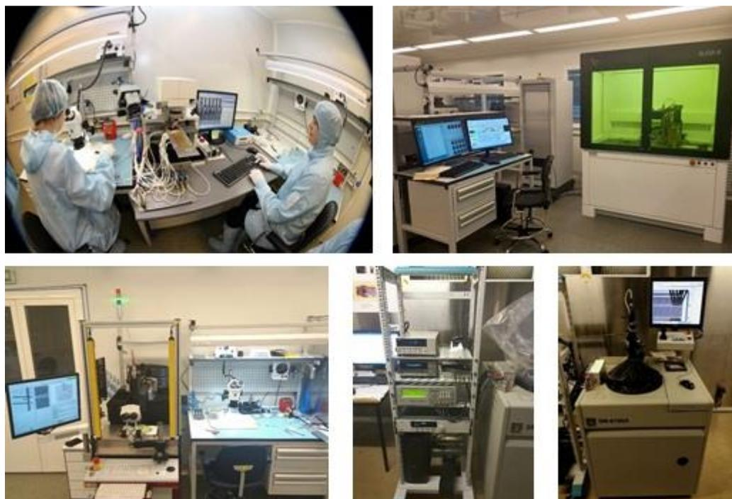
Рис. 37. Участок сборки модулей микростриповых детекторов и робот-укладчик MAPS (вверху); участок сборки и сертификации трековых систем с измерительным стендом для сертификации двусторонних микростриповых сенсоров (внизу).
