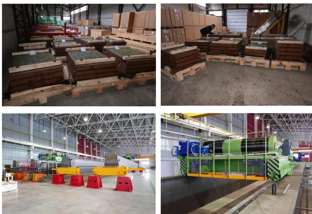
Рис. 47. Фундаментные плиты (сверху) и краны (снизу) для павильонов МРД и SPD.
