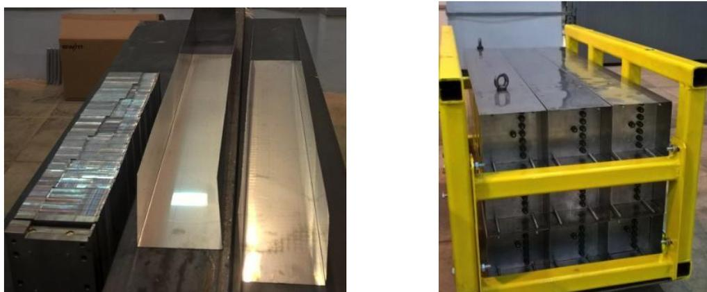
Рис. 35. модуль и супермодуль FHCAL (справа).
