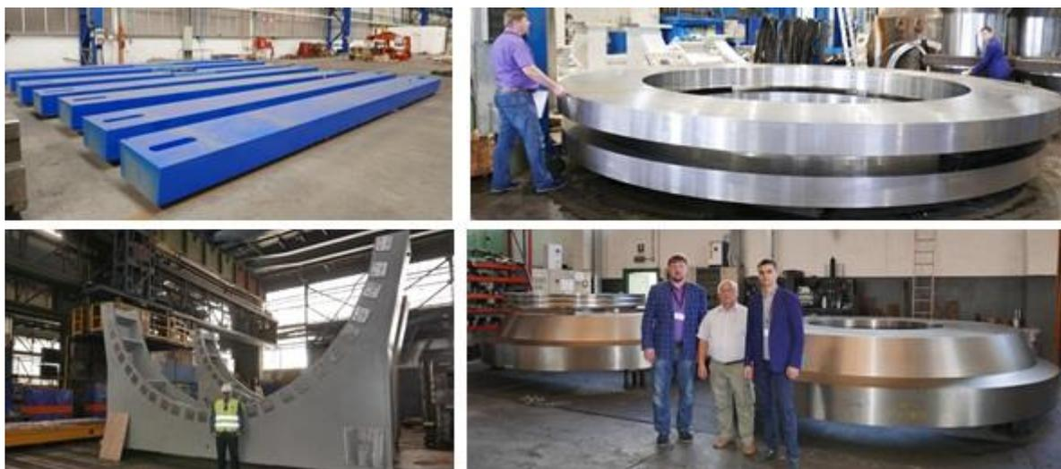
Рис. 28. Балки магнитопровода (слева сверху), ложементы для их поддержки (слева внизу), поддерживающие кольца (справа сверху) и торцевые заглушки (справа внизу) соленоидального магнита установки MPD.
