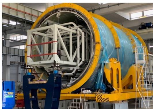
*Рис. 2.2.1.3. Одна из корректирующих обмоток (слева) и соленоид в криостате (справа).*
