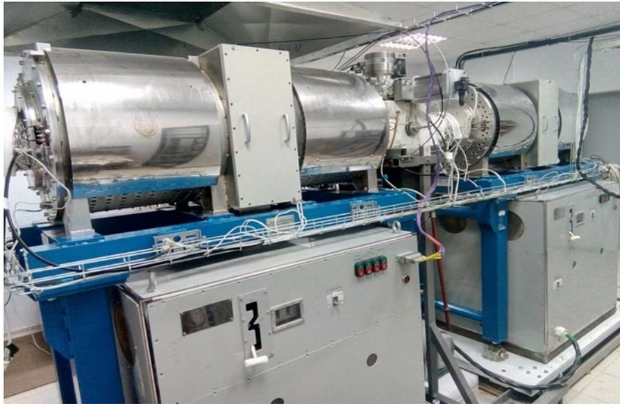
*Рис. 2.1.2.6. Ускорительные станции Бустера на испытательном стенде ОИЯИ*
