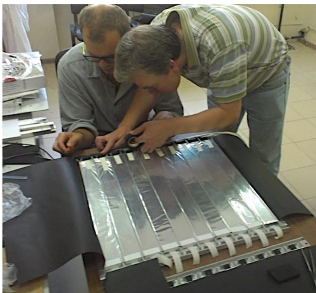
*Рис. 2.2.1.26. Изготовление сцинтилляционных плоскостей.*
