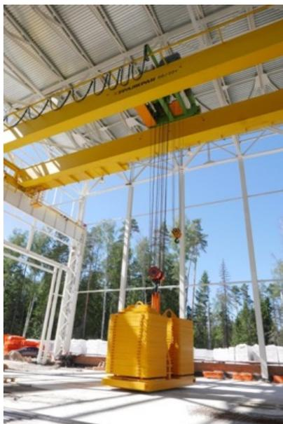
*Рис .2.3.4.2. Статические испытания крана г/п 80 тонн. Вес контрольного груза 100 тонн*
