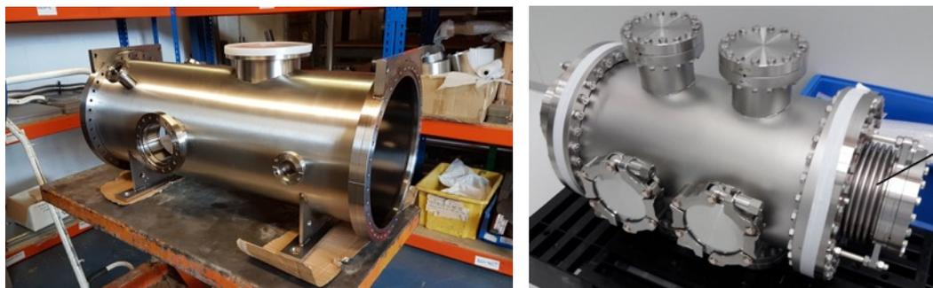
*Рис. 2.1.2.13. Электростатический септум ESS в процессе изготовления (слева) и инфлекторные пластины IP2 (справа).*
