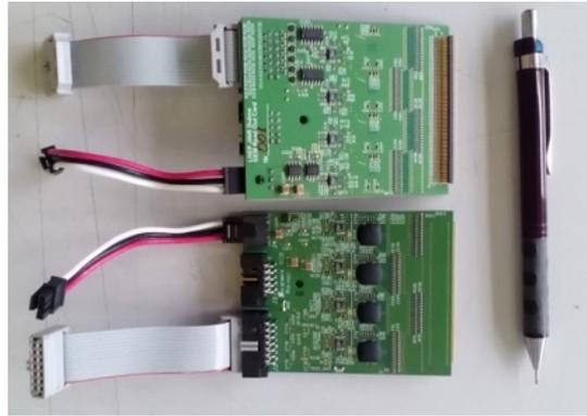
*Рис. 2.2.2.3. 128 канальная плата считывания данных (передняя и задняя стороны).*
