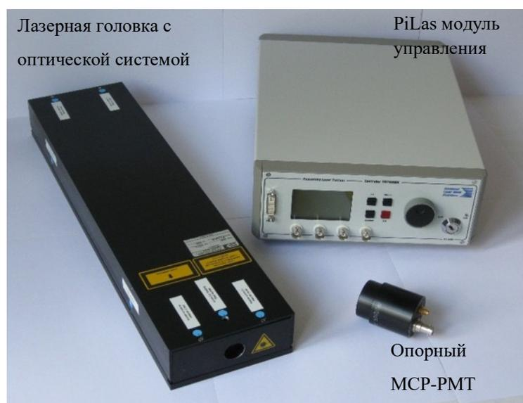
*Рис. 2.2.1.27. Вид PiLas модуля управления, модуля с лазерной головкой и оптической системой и опорного фотодетектора MCP-PMT PP0365G.*
