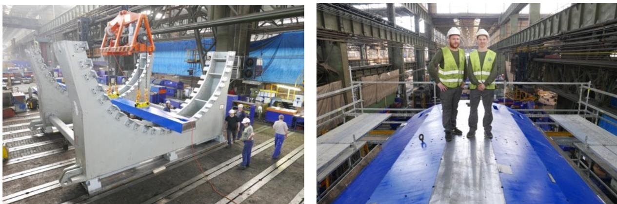
*Рис. 2.2.1.9. Установка первой нижней плиты магнитопровода (слева), магнитопровод собран (справа).*
