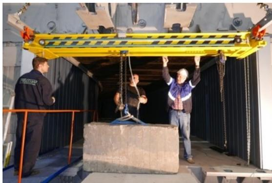
*Рис. 2.3.4.1. Монтаж и испытания кран балок Бустера.*
