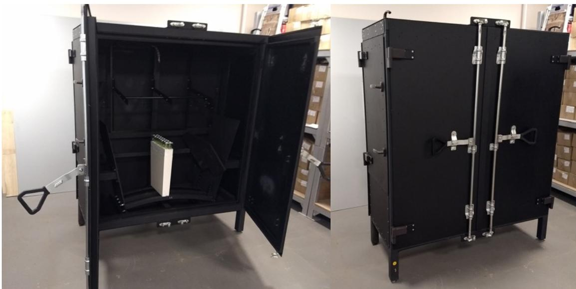
*Рис. 2.2.1.38. Прототип стенда для одновременного тестирования 12-ти модулей ECal на космических мюонах.*
