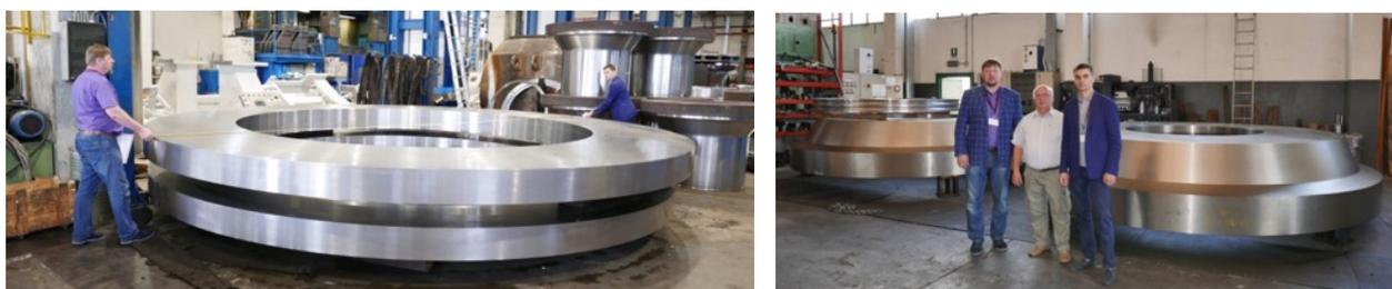
*Рис. 2.2.1.8. Поковки опорных колец и полюсов после предварительной обработки с припуском 5 мм на контур.*
