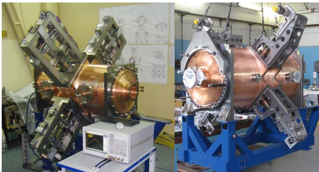
Рис. 2.1.4.3. Станция ВЧ2 (слева) и ВЧ3 (справа) Коллайдера.
