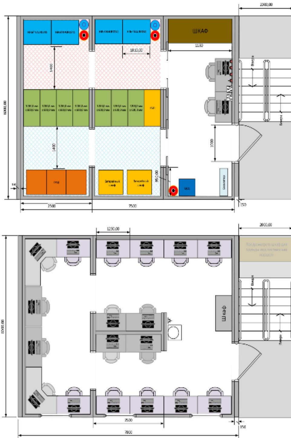
Рис. 2.2.1.45. Схемы MDC (сверху) и зала управления (внизу).
