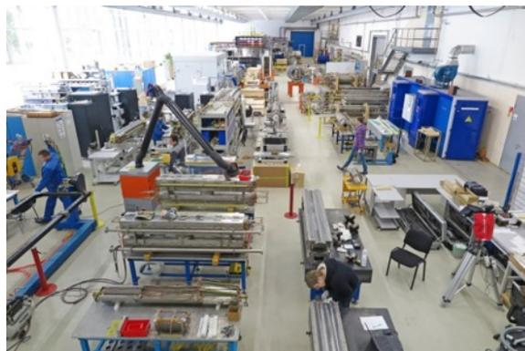
Рис. 2.3.8.1. Линия сборки и испытаний СП магнитов: схематическое изображение (слева), общий вид (справа).
