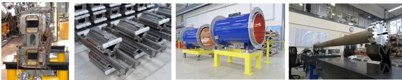
Рис. 2.1.4.1. Слева направо: дипольный магнит, квадрупольные линзы, криостаты и высоковакуумная пучковая камера Коллайдера.
