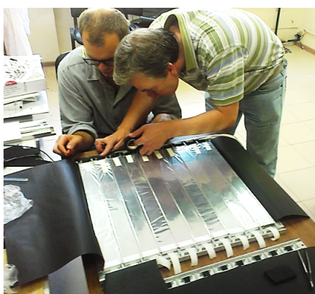
Рис. 25. Сборка плоскостей из пластиковых сцинтилляторов и SiPMs для триггирования космических мюонов и схема триггера стенда для испытаний FFD.
