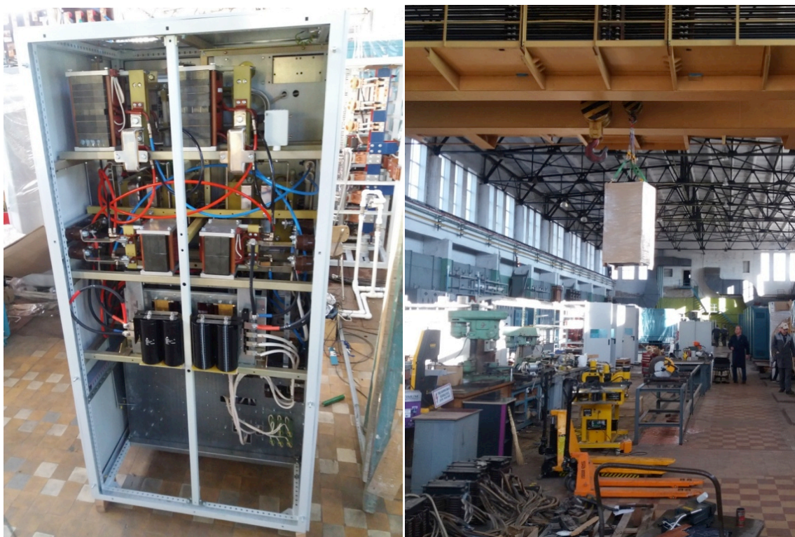
Рис. 8. Шкаф преобразователя источника питания Бустера (слева), транспортировка источников питания Бустера в корп. 1А.
