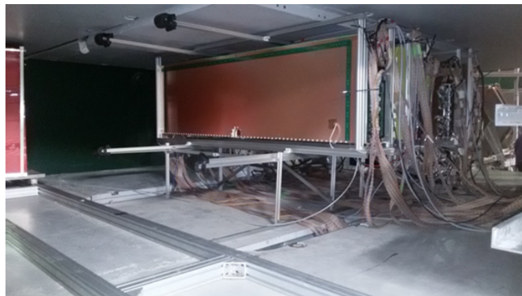
Рис. 42. Координатные детекторы GEM внутри спектрометрического магнита установки BM@N .
