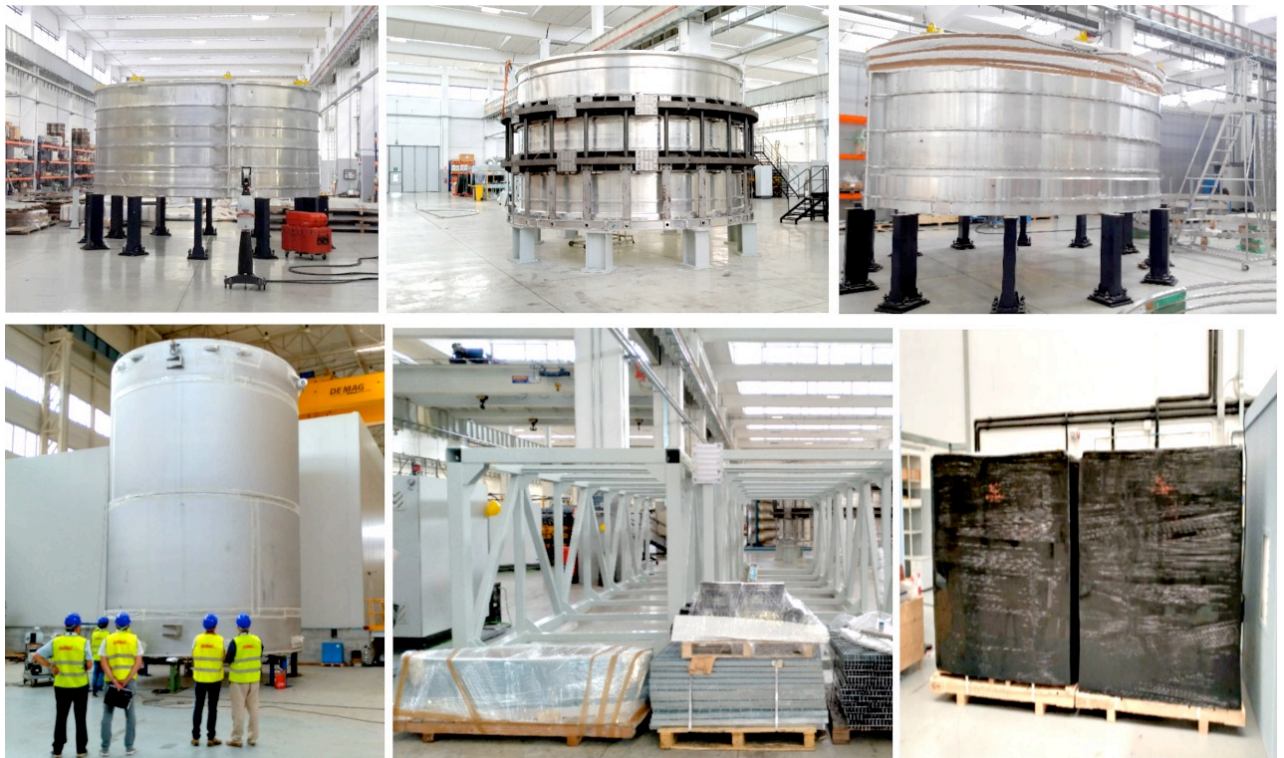
Рис. 15. Все три готовые модуля сверхпроводящей катушки соленоида (вверху слева, вверху в центре, вверху справа), криостат соленоида (внизу слева), оборудование для сборки соленоида (внизу в центре), оборудование системы электропитания в упаковке (внизу справа).
