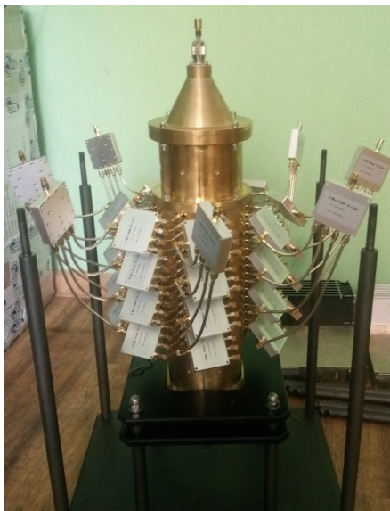
Рис. 14. Прототип пикапа/кикера ССО Коллайдера на испытательном стенде.
