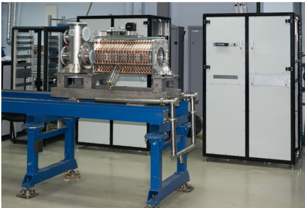
Рис. 11. Станция ВЧ-1 в процессе сборки и подготовки к стендовым испытаниям. На заднем плане видны стойки (шкафы) питания 2-х станций
