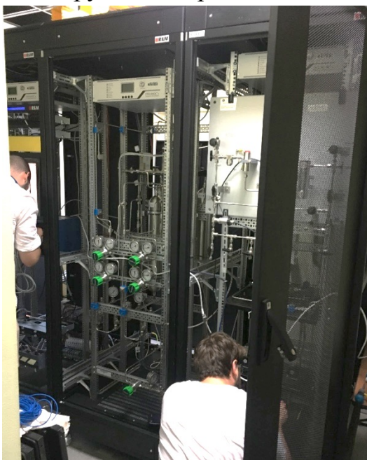
Рис.23. Газовая система с замкнутым контуром для TOF во время сборки
